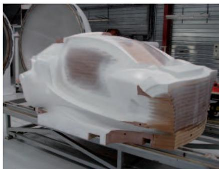
&gt;&gt; Master ou maître modèle usiné servant à réaliser le moule
